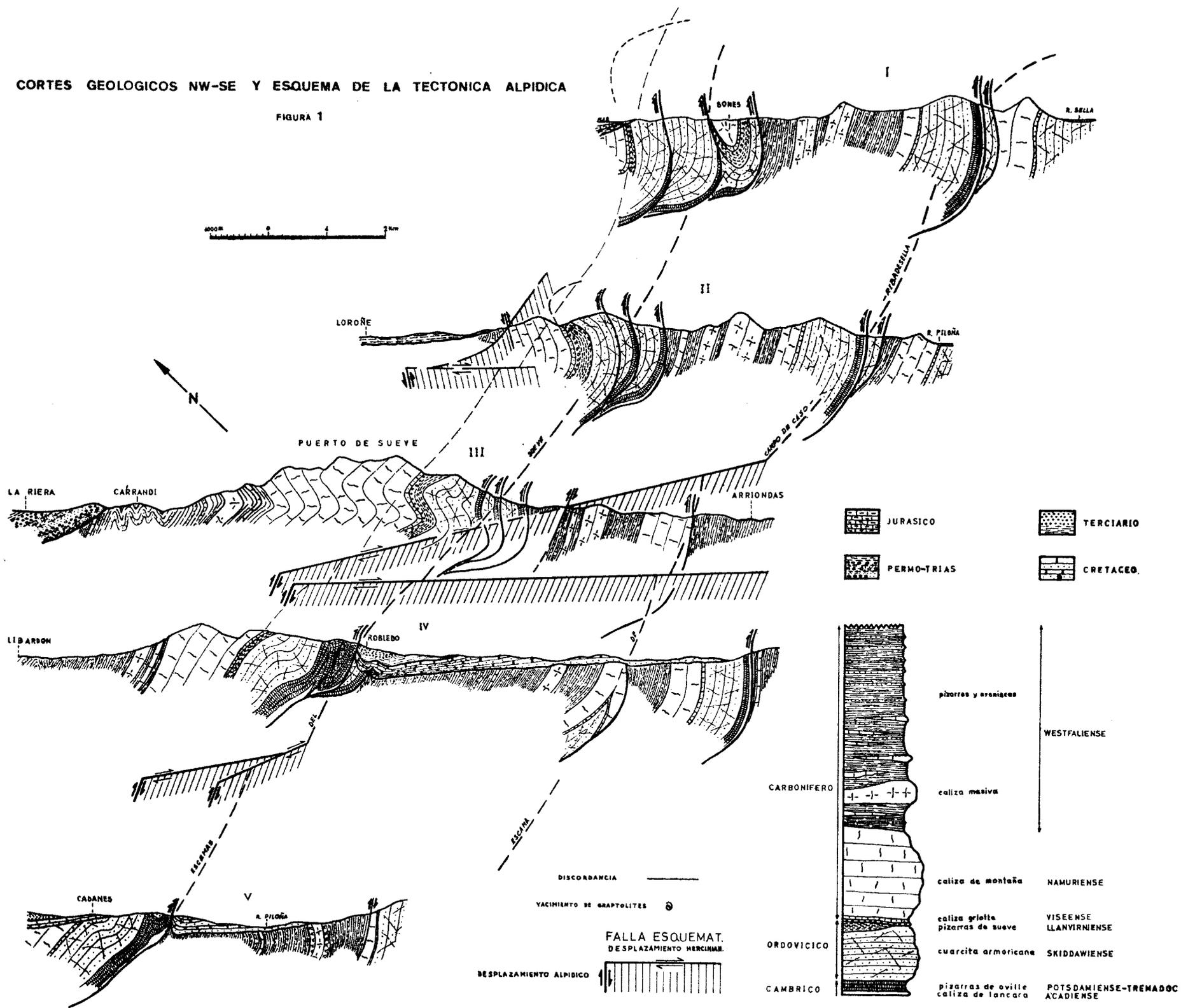
En la tectónica de estos frentes se observa un nivel de despegue tipo apalachense por debajo de las calizas y dolomías acadienses (JULIVERT, 1965, 1967), que en ocasiones asciende a niveles superiores.
