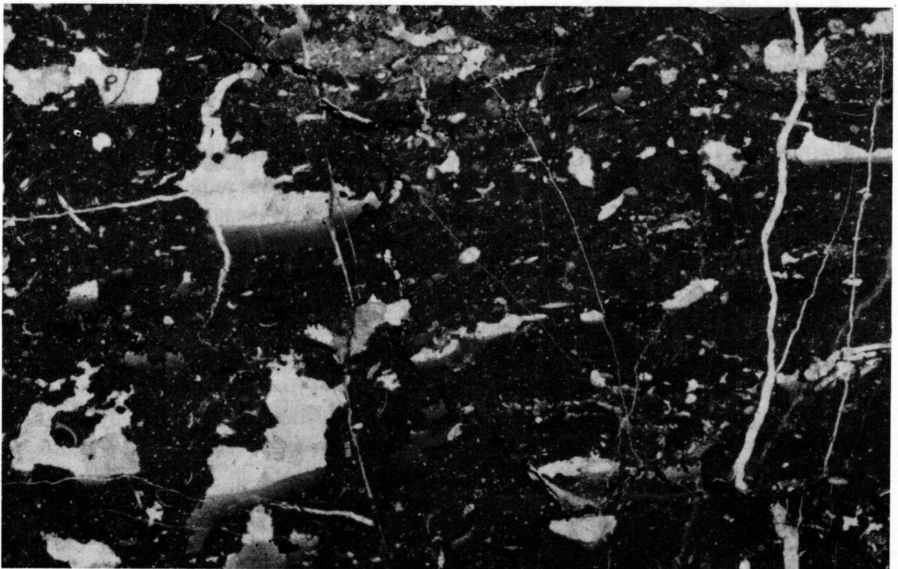
Fig. 4.—Caliza con birdeseyes rellenos parcialmente de esparita y barro calcáreo y algunos pocos de esparita. El armazón es una micrita fosilífera con Calcisferas y Ostrácodos (muestra M-11, miembro inferior)  $\times 10$ .
