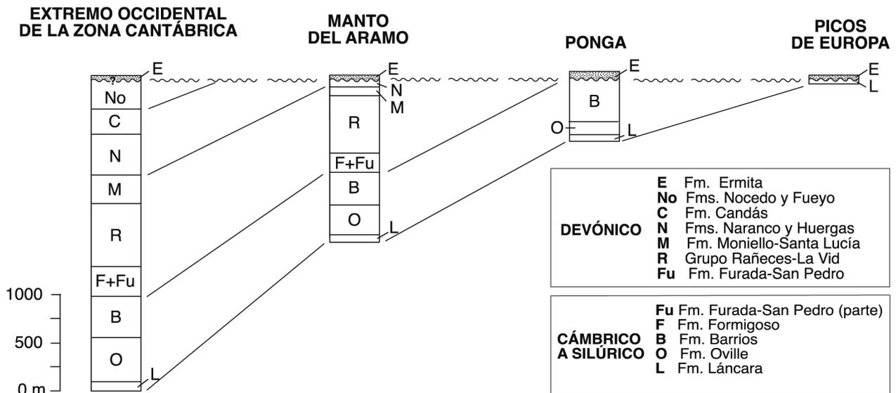
**Figura 3.** Esquema estratigráfico mostrando el truncamiento de las formaciones pre-Famenienses a consecuencia de la disposición discordante de la Formación Ermita en una sección E-O a través de la Zona Cantábrica. La situación de las localidades correspondientes a las diferentes columnas estratigráficas puede observarse en la Fig. 1.
